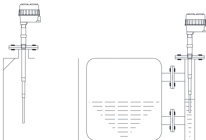
开放池的支架安装
